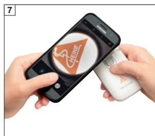
7 El imán del connector sujeta ahora el teléfono móvil junto con el soporte sobre el anillo de enfoque del dermatoscopio.
