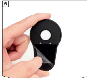
5 Retire la película protectora y presione firmemente el connector en el centro delante de la lente de cámara seleccionada.
