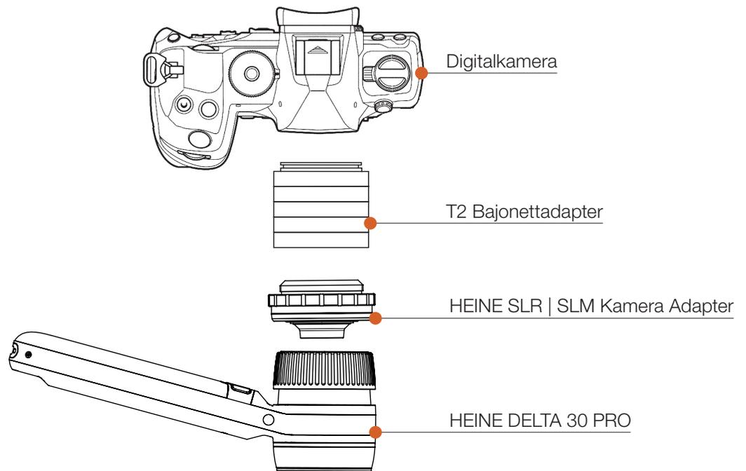
**Optimieren Sie Ihr HEINE Dermatoskop mit dem SLR | SLM Kamera Adapter.** Die Kombination aus dem HEINE DELTA 30 oder HEINE DELTA 30 PRO, dem HEINE SLR | SLM Kamera Adapter und einer DSLR oder DSLM Kamera bietet ein umfassendes System, um Aufnahmen mit gleichbleibend hoher Qualität zu dokumentieren.
